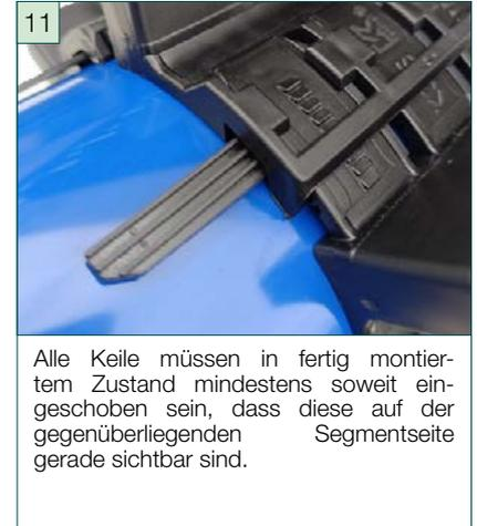
Alle Keile müssen in fertig montiertem Zustand mindestens soweit eingeschoben sein, dass diese auf der gegenüberliegenden Segmentseite gerade sichtbar sind.
