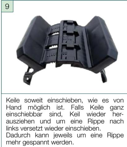
Keile soweit einschieben, wie es von Hand möglich ist. Falls Keile ganz einschiebbar sind, Keil wieder herausziehen und um eine Rippe nach links versetzt wieder einschieben. Dadurch kann jeweils um eine Rippe mehr gespannt werden.
